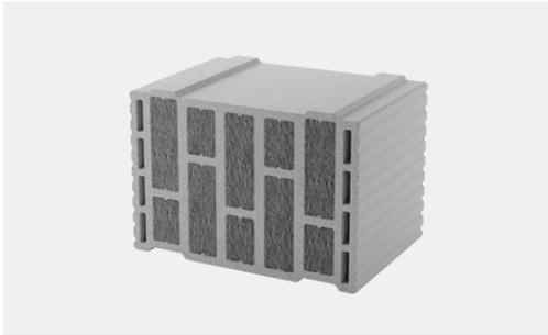
Der ThermoPlan® MZ 80 G Planstein wird mit einem Dünnbettmörtel mit einer Fugenstärke von 1-3mm verklebt. Der zum System passende Dünnbettmörtel wird mitgeliefert.
