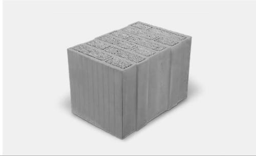
Der ThermoPlan® MZ 70 Planstein wird mit einem Dünnbettmörtel mit einer Fugenstärke von 1-3mm verklebt. Der zum System passende Dünnbettmörtel wird mitgeliefert.
